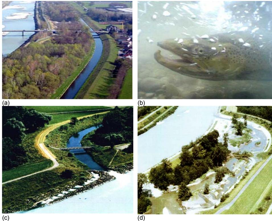
Fig. 4-17: Liechtensteiner Binnenkanal ( $MQ=4,92 \text{ m}^3 \text{ s}^{-1}$ ): (a) parallel zum Alpenrhein wird das Wasser aus 12 Zuflüssen abgeleitet, (b) Seeforelle, die im Binnenkanal wichtige Laichhabitate findet, (c) 1985 Mündung des Binnenkanals bei Ruggell mit Fischtreppe und einem 4 m hohen Absturz (d) Neugestaltung August 2000 (Fotos: Büro Hydra, E. Ritter, Tiefbauamt Vaduz).
