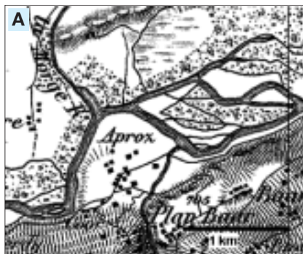
Bild 2. Auswirkungen der flussbaulichen Massnahmen an der Rhone in der Region von Aproz. A: Situation um 1850 (Dufourkarte). B: Aktuelle Situation (Landeskarte 2003). Reproduziert mit der Bewilligung von swisstopo (BA046601).
